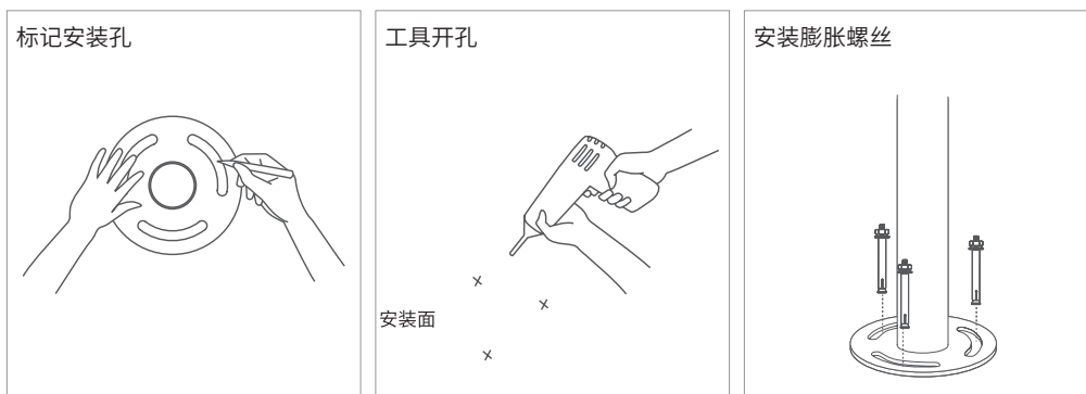
图3-3 立柱安装示意图
